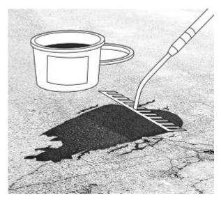
2. Mit einer Schaufel die benötigte Menge EASYPHALT® Kaltasphalt leicht überhöht einbringen und mit einem Rechen verteilen.
